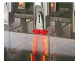
Prova in acqua delle proprietà dielettriche a 10000 V. Dielectric water bath test to 10000 V.
