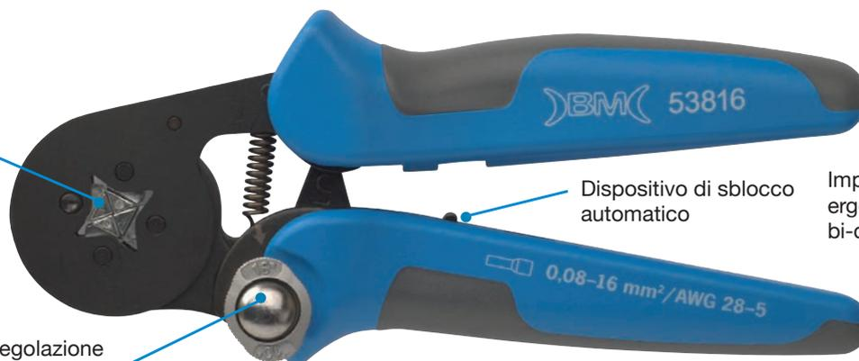
Dispositivo di sblocco automatico
