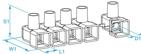
**CORPO ISOLANTE:** policarbonato (PC) trasparente UL 94 V0
