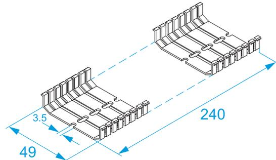
Accessorio per il corretto posizionamento dei cavi in entrata e in uscita, per aumentare il grado di isolamento tra morsettiere e superficie d'appoggio, e per proteggere dall'uscita accidentale di trefoli dal corpo del morsetto. Pretaglio per un facile dimensionamento in funzione del numero dei poli della morsettiere.
